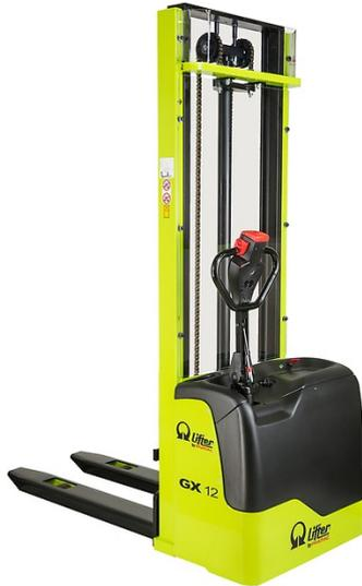
Die neue GX Baureihe ist die ideale Deichselstapler Lösung für den gewerblichen Gelegenheitseinsatz auf kleineren bis mittleren Lagerflächen. Mit einer Gesamtbreite von nur 800 mm und der seitlich angeordneten Deichsel ist der neue GX äußerst wendig, standfest und ermöglicht immer freie Sicht zu den aufzunehmenden Lasten
